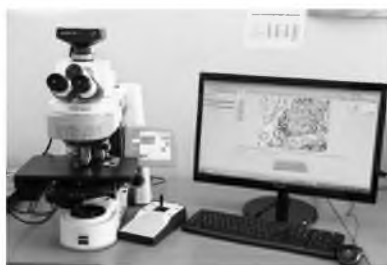
Рис. 4. Комплекс оборудования для морфометрических исследований, состоящий из микроскопа Axio Imager M2, цифровой камеры и специальной программы ZEN 2012 для ввода изображений, проведения измерений и документирования, ZEISS (Германия)
